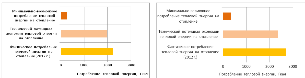
(б) Технический (максимально возможный) потенциал экономии тепловой энергии на отопление для двух групп многоквартирных жилых домов
