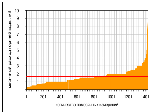
(б) Потребление горячей воды в среднем на одного проживающего в 100 квартирах г. Тюмени, оснащенных квартирными приборами учета расхода горячей воды
