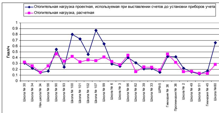
Рис. 1. Договорные и уточненные отопительные нагрузки
